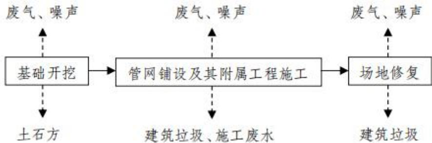
图 2-3 管网铺设施工期工艺流程及产污节点图
