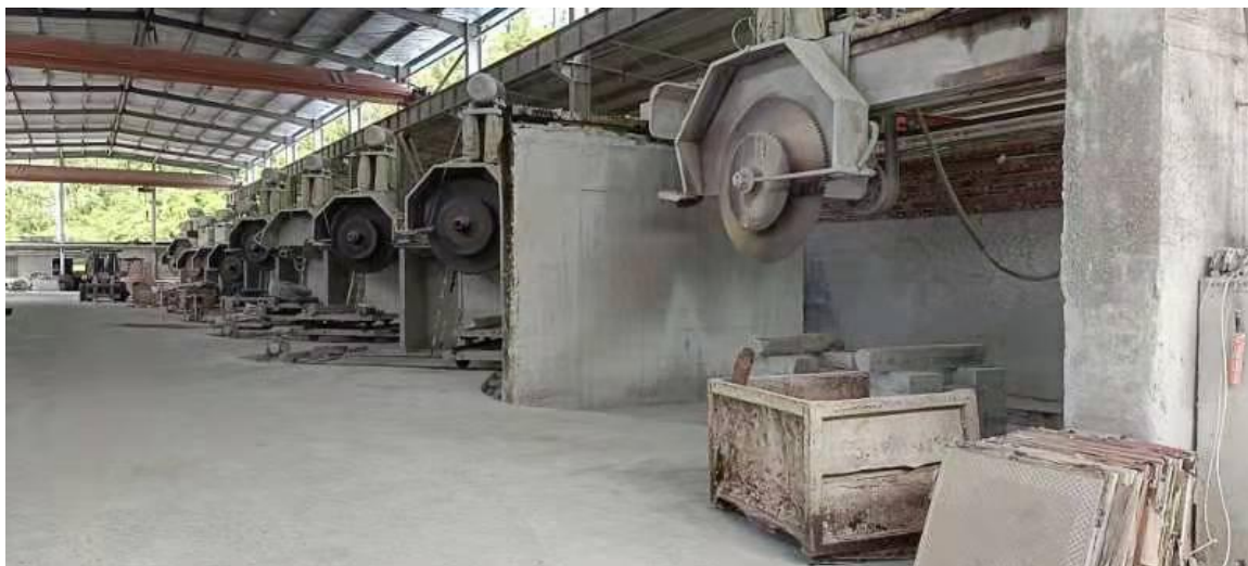
切割区石材切割、打磨车间
